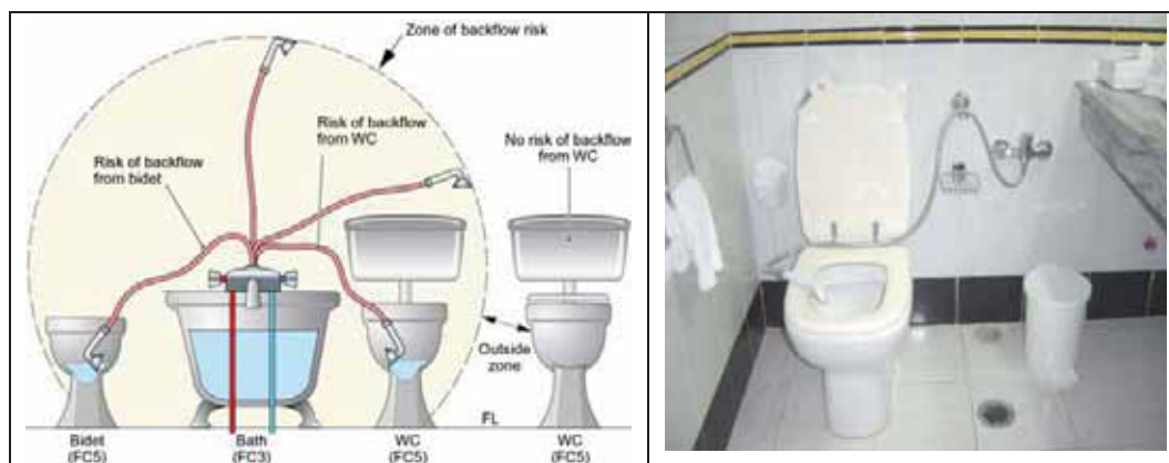
Figur 2.5 Eksempel på mulig tilbagesugning fra forskellige typer af installationsgenstande
