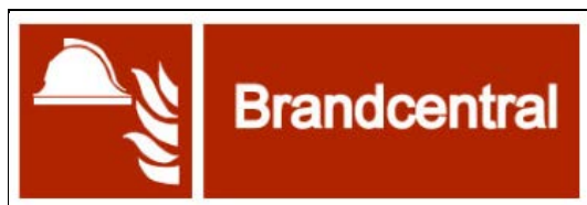
Figur 5.5.1.a: Eksempel på markering af adgangsdøren til brandcentral.
