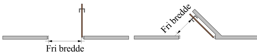
Figur 2.11. Måling af en dørs frie bredde ved henholdsvis en åbning på 90° og ved åbning på mindre end 90°.
