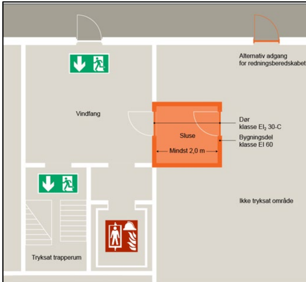
Figur 05.09.05: Sluse til vindfang for ATA-anlæg
