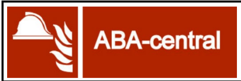
Figur 05.01.01: Eksempel på markering af adgangsdøren til ABA-central
