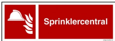
Figur 05.02.01: Eksempel på markering af adgangsdøren til sprinklercentral
