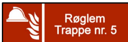
Figur 5.11.2 Eksempel på markering af røglem med undertekst.
