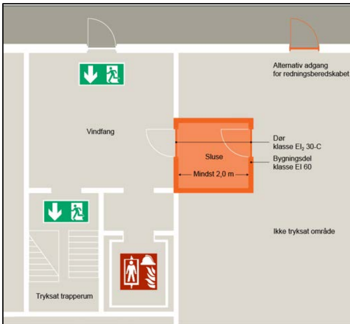
Figur 5.9.5 Sluse til vindfang for ATA-anlæg.
