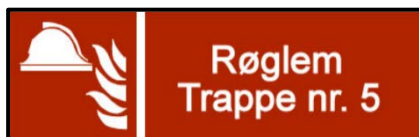
Figur 5.11.2 Eksempel på markering af røglem med undertekst.
