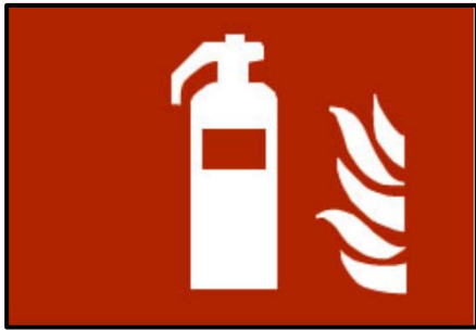
Figur 6.1.1 Eksempel på markering af håndildslukker.
