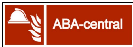
Figur 5.1.1 Eksempel på markering af adgangsdøren til ABA-central.
