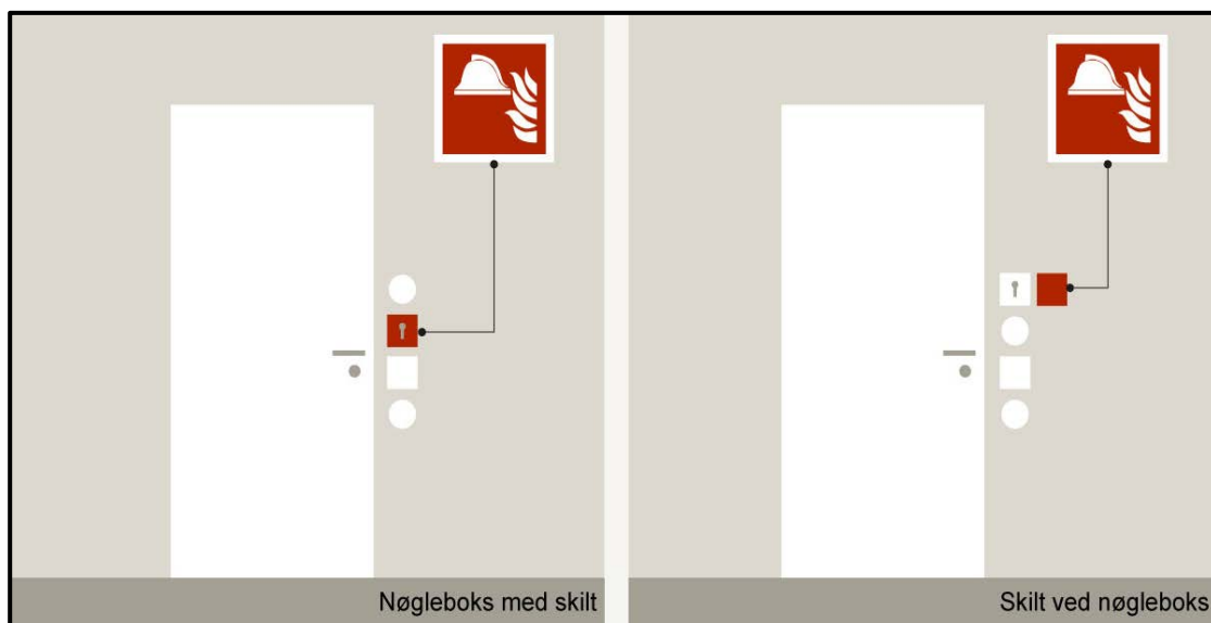
Figur 5.1.4 Eksempler på skiltning af nøglebokse.
