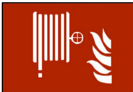
Figur 5.6.1 Eksempel på piktogram for markering af slangevinder.
