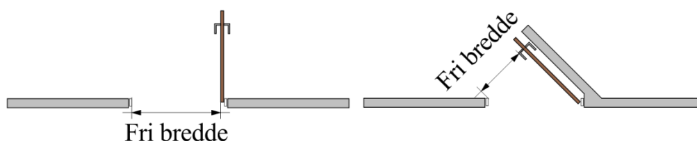
Figur 2.8. Måling af en dørs frie bredde ved henholdsvis en åbning på 90° og ved åbning på mindre end 90°.
