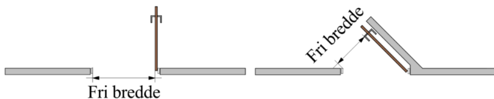
Figur Fejl! Ingen tekst med den anførte typografi i dokumentet..65. Måling af en dørs frie bredde ved henholdsvis en åbning på 90° og ved åbning på mindre end 90°.
