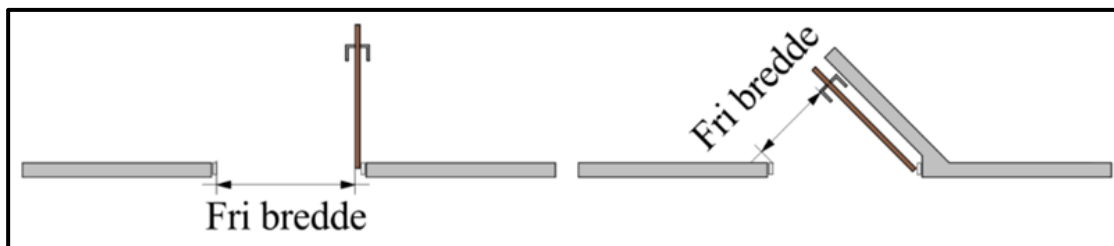
Figur 2.3.14 Måling af en dørs frie bredde ved henholdsvis en åbning på 90° og ved åbning på mindre end 90°.
