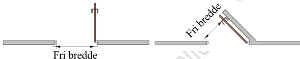
Figur 2.65. Måling af en dørs frie bredde ved henholdsvis en åbning på 90° og ved åbning på mindre end 90°.
