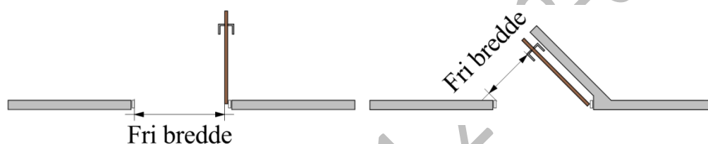
Figur 2.9. Måling af en dørs frie bredde ved henholdsvis en åbning på 90° og ved åbning på mindre end 90°.
