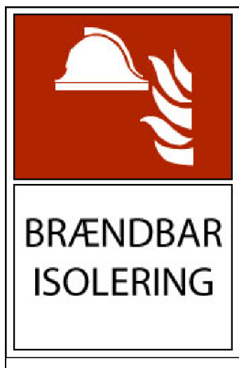
Figur 4-2 Eksempel på udformning af skilt til mærkning af bygninger med brændbar isolering.
