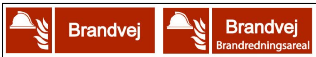
Figur 5.2.5.a: Skilte til markering af brandveje og brandredningsarealer.
