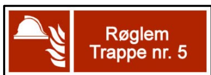
Figur 5.7.0.1.b: Eksempel på skiltning af røglem med undertekst.
