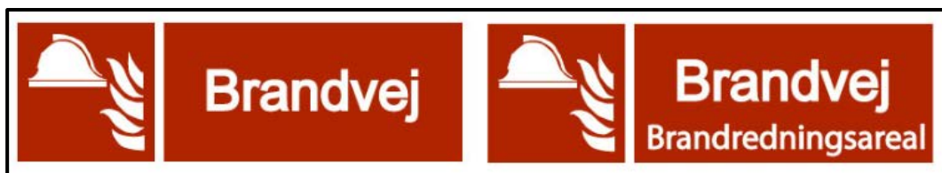
Figur 5.2.5.a: Skilte til markering af brandveje og brandredningsarealer.
