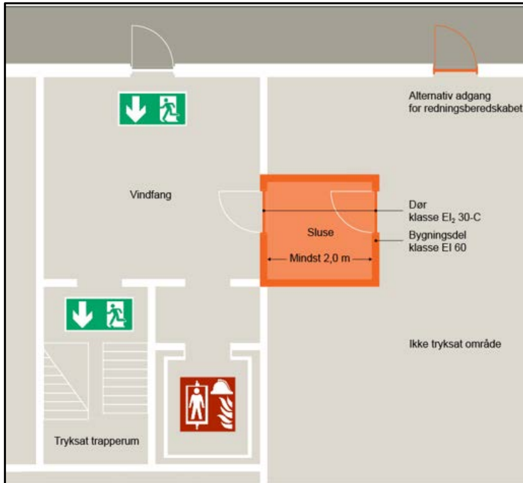
Figur 05.09.05: Sluse til vindfang for ATA-anlæg
