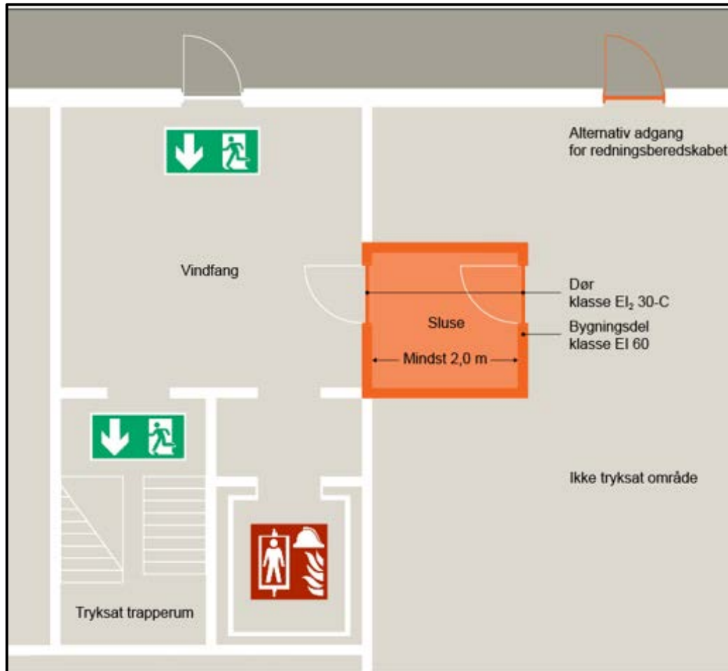
Figur 05.09.05: Sluse til vindfang for ATA-anlæg
