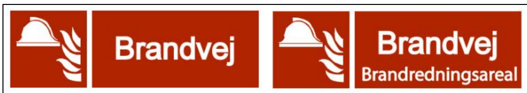
Figur 5.2.5.a: Skilte til markering af brandveje og brandredningsarealer
