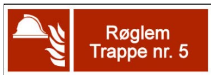
Figur 5.7.0.1.b: Eksempel på skiltning af røglem med undertekst.
