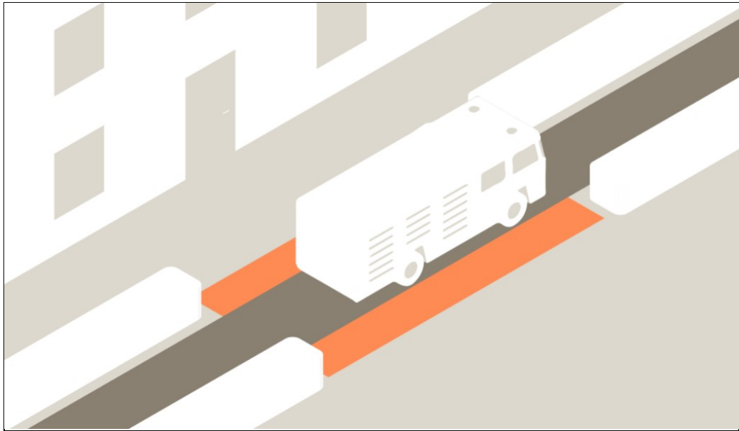
Figur 5.2.4.c: Eksempel på placeringen af udstigningsarealer
