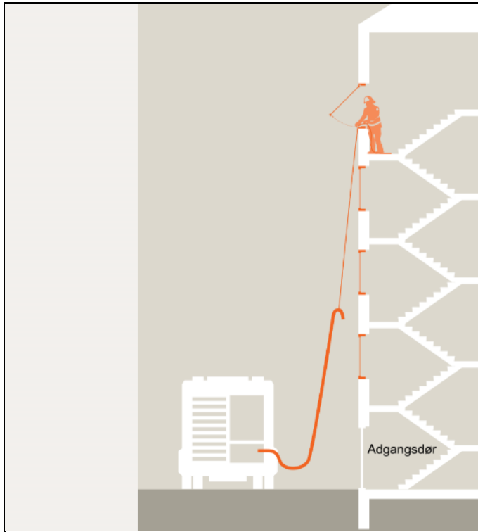
Figur 5.5.9.a: Sidelysvinduer til udvendig ophaling af slanger
