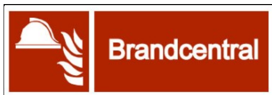
Figur 5.5.1.a: Eksempel på markering af adgangsdøren til brandcentral.
