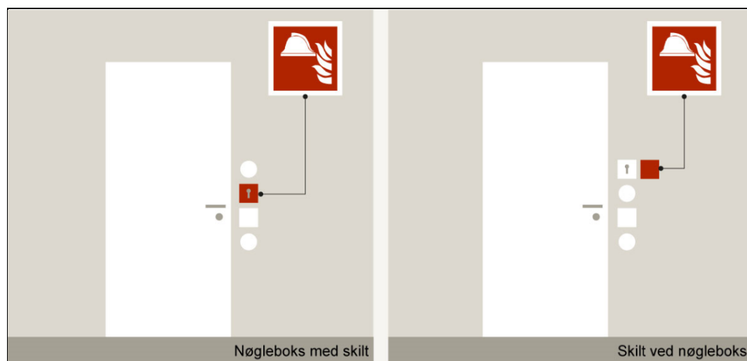
Figur 5.3.2.1.b: Eksempler på skiltning af nøglebokse
